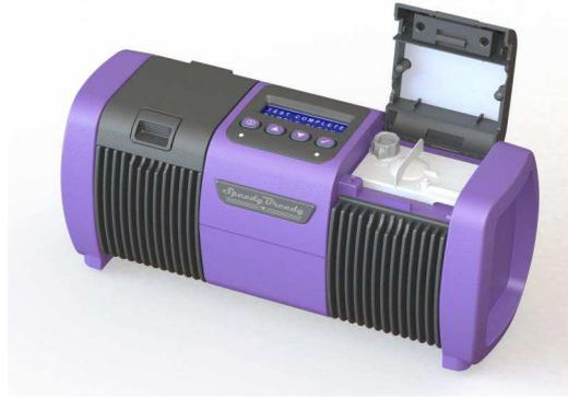
Speedy Breedy est un instrument portable composé de deux chambres d'analyse indépendantes. Les chambres de culture à usage unique pré-remplies avec un milieu de culture sélectif ou non, sont conçues pour maintenir des conditions optimales de croissance du micro-organisme recherché.
